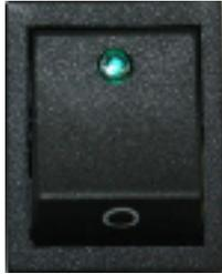
Abb. 44: Netzschalter
