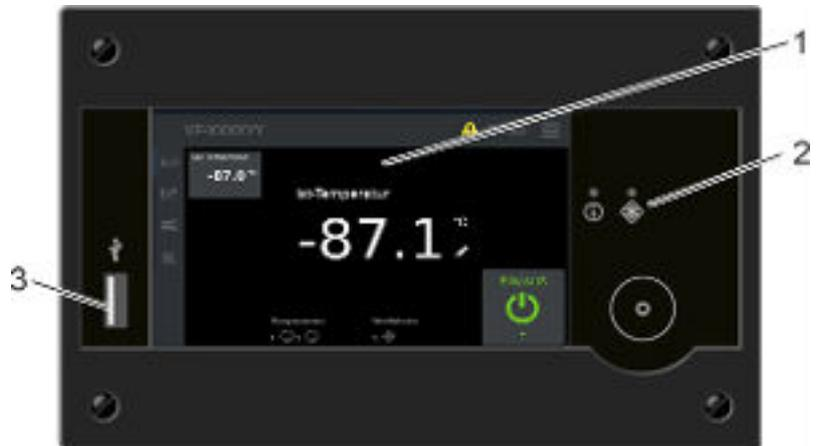
Abb. 6: Bedieneinheit Touch
